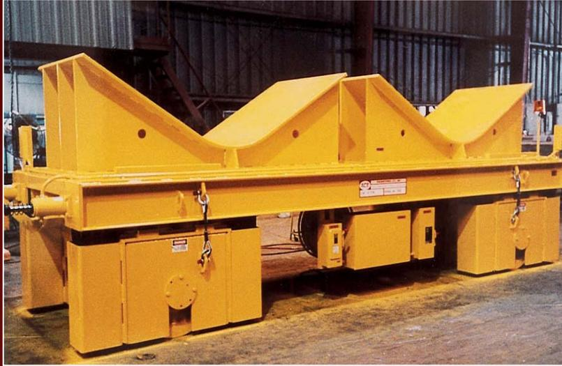
*Carro de transferencia diseñado con amortiguadores en las ruedas para prevenir daño a los rollos*
