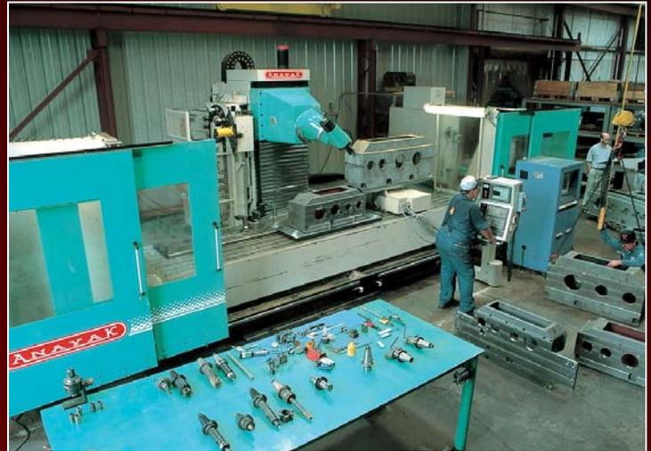
Centro de maquinado CNC de 5 ejes para la fabricación de cajas de engranes de alta exactitud
