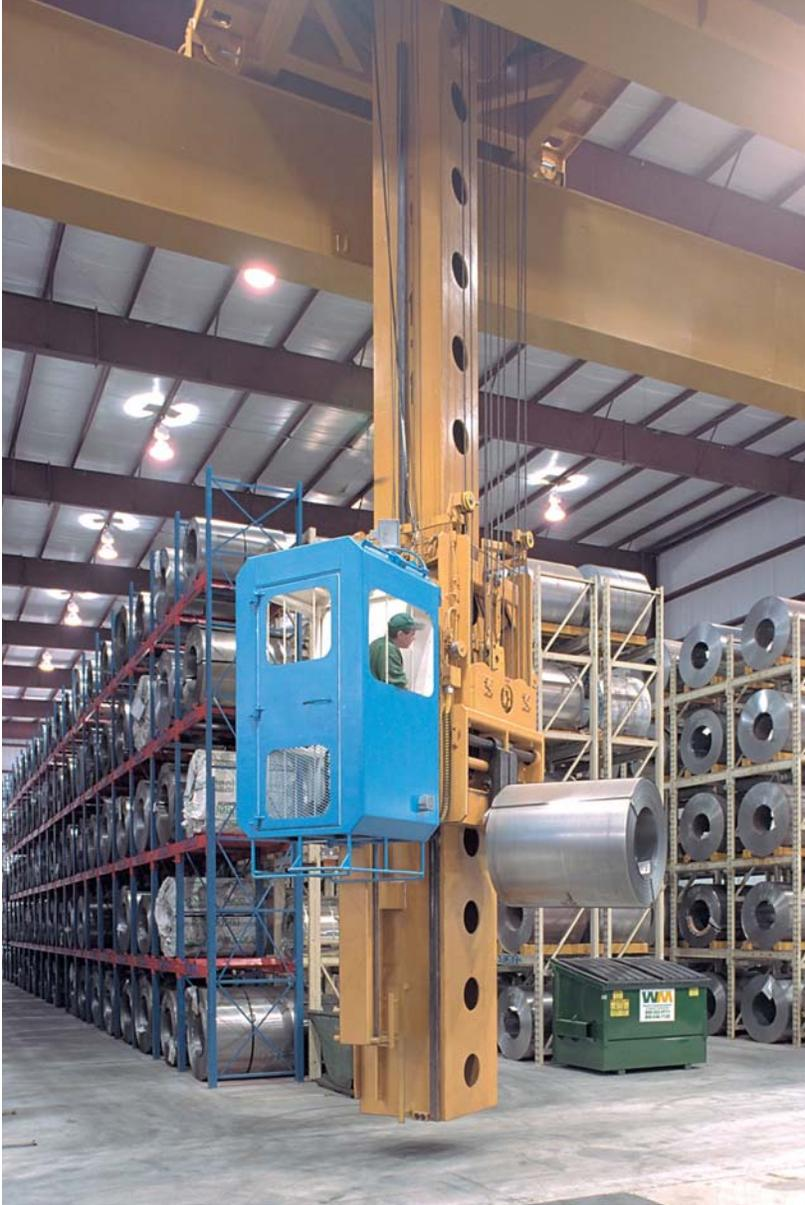
*Grúa apiladora con mástil Rotatorio telescópico de 25 Toneladas de capacidad con cabina de movimiento independiente para el manejo de rollos y tarimas*
